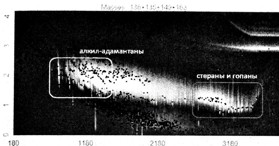
Рис.4. Двумерная хроматограмма в 2D представлении для суммы характеристических ионов алкил-адамантанов m/z 135,136,149,163 в пробе из нефтяного сипа
