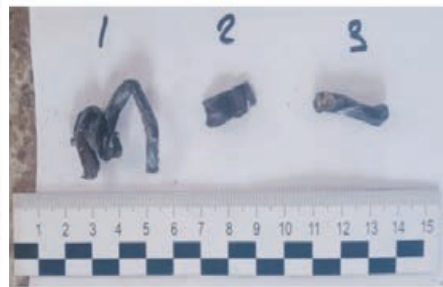
Fig. 22. Часть поврежденных металлических объектов, извлеченных из отсека гидросистемы № 2 в отсеке управления стабилизатором
