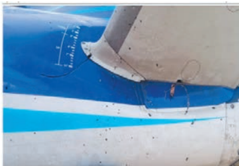
Fig. 10. Повреждения левой стороны горизонтальной части
