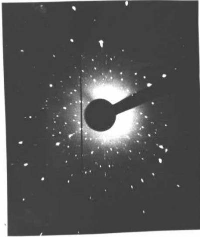
a) TmAsSe b) TmAsSe 3 Şək. 2. TmAsSe və TmAsSe 3 birləşmələrinin laueqramları.
