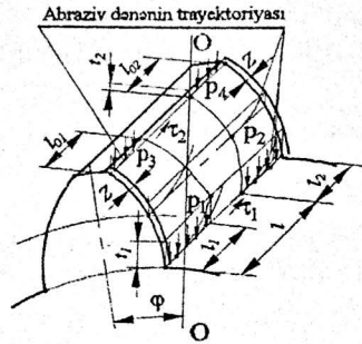
Şəkil 1. Dişlərin sürətköçürmə ilə pardaqlanmasında səthə təsir edən dəyişən amillərin sxemi
