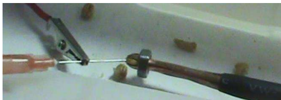
Səh. 2. B7-35 millivoltmetri üçün hazırlanmış elektrod
