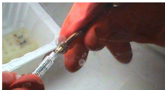
Səh. 3. Yeni yaradılmış millivoltmetr üçün hazırlanmış elektrod
