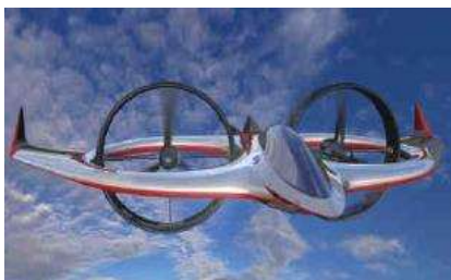
Şəkl. 1. "Project Zero" elektrik konvertoplanının üfüqi uçuş zamanı mühərriklərin vəziyyəti
