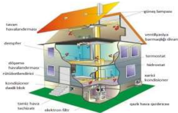
Şəkil 1. Evlərdə hava istilik cihazının diaqramı
