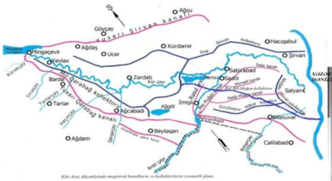
Рисунок 1- Схематичный план основных магистральных каналов и коллекторов в Куро-Аразской равнине
