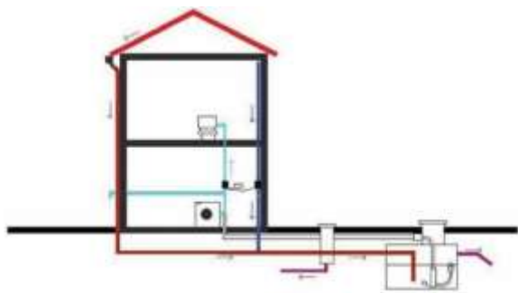
Şəkil 1. Şəbəkənin yağış suyu ilə birbaşa təchiz edilməsi
