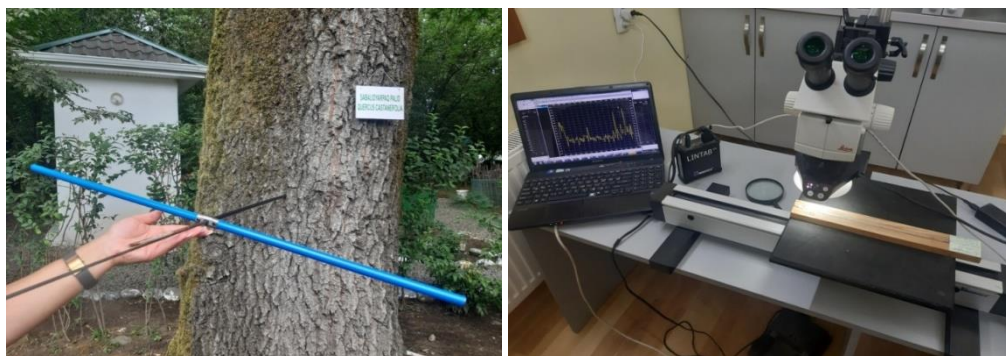
A B Şəkil 1. Gövdədən nümunələrin götürülməsi (A) və LİNTAB6 binokulyar mikroskopunda tədqiqi (B)
