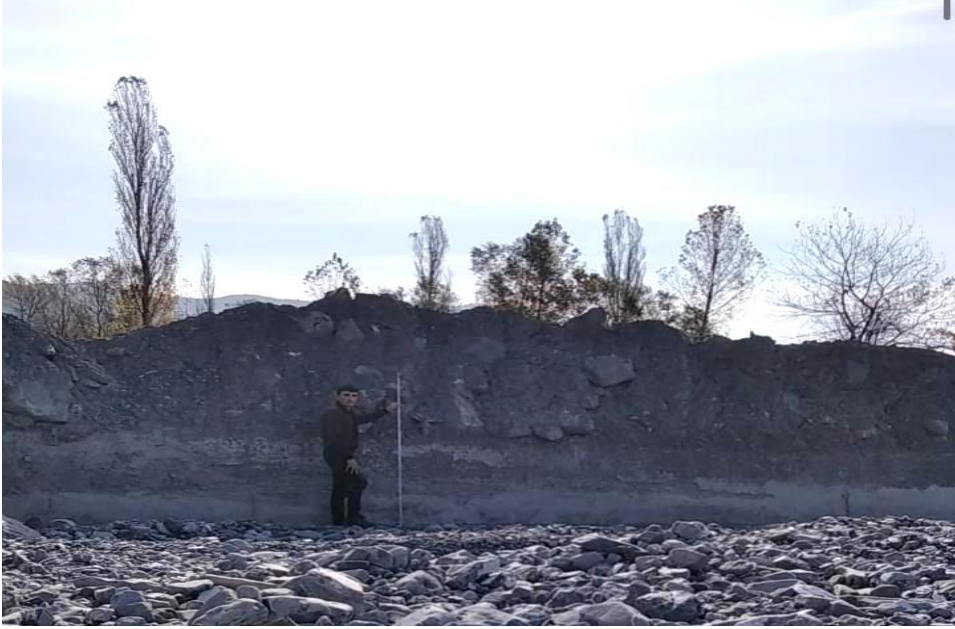
Şəkil 3. 07 Sentyabr 2023- cü il tarixdə Şin çayında baş vermiş güclü sel hadisəsindən sonra ölçü işləri apararkən. Baş vermiş sel hadisəsi nəticəsində Baş Göynük kəndinin ətrafında mövcud olan müdafiə bəndinin üzərində 1.70 m hündürlükdə gətirmə konuslarının toplandığı müşahidə olunur. Sentyabr 2023.
