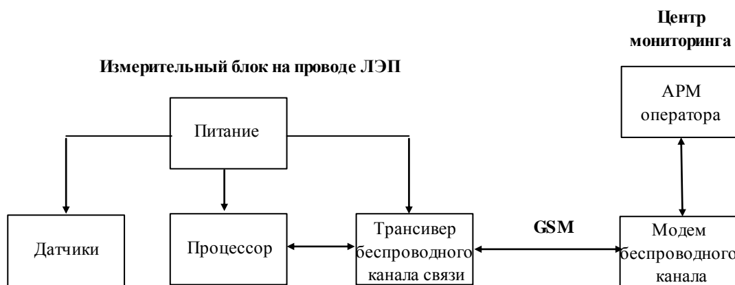
Рис 2. Система мониторинга провода ЛЭП
