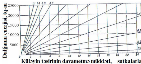
Şəkil 3.79. Küləyin təsirinin davam etmə müddətinə və 0,1 %-li təminatlı dalğa hündürlüyünə görə dalğanın enerjisinin təyini qrafiki (Y.Q.Kaçuginə görə).
