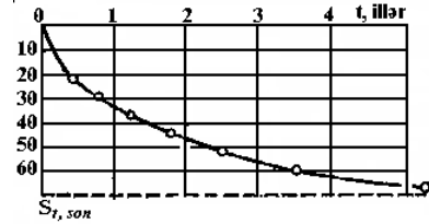
Şəkil 2.47. Qrun təbəqəsinin səthinin çökməsinin (hesabi qiymətinin) zamana görə dəyişməsi.
