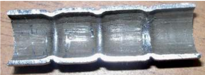
Şəkil 2.96. Həlqəvi diskret qanovcuqlu boru
