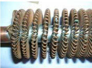
Şəkil 2.105. Qabırğalamanın növləri:
