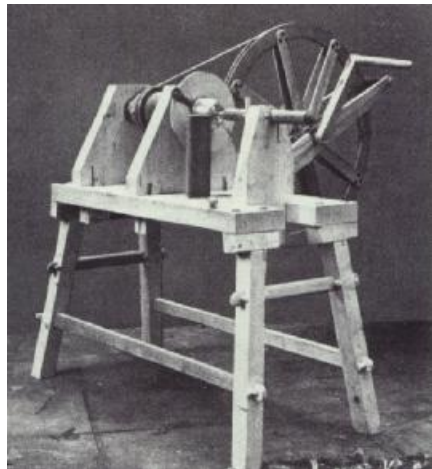
Şəkil 1.19. Romada tətbiq olunan torna dəzgahının rekonstruksiyası.
