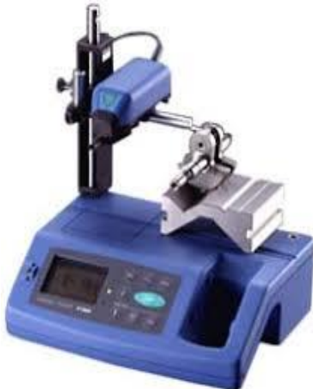
Səthin kələ kötürlük ölçən– TR 200 markalı
