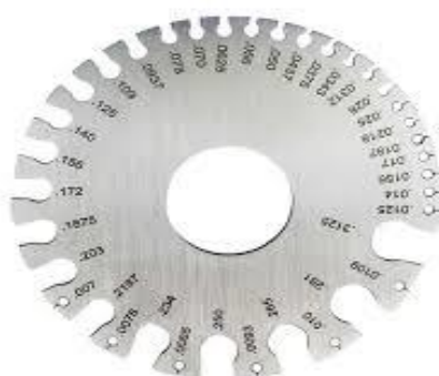
Калибр – толщине линейка Горячая – 0 – 36 крупный AWG для Сварочного контроля
