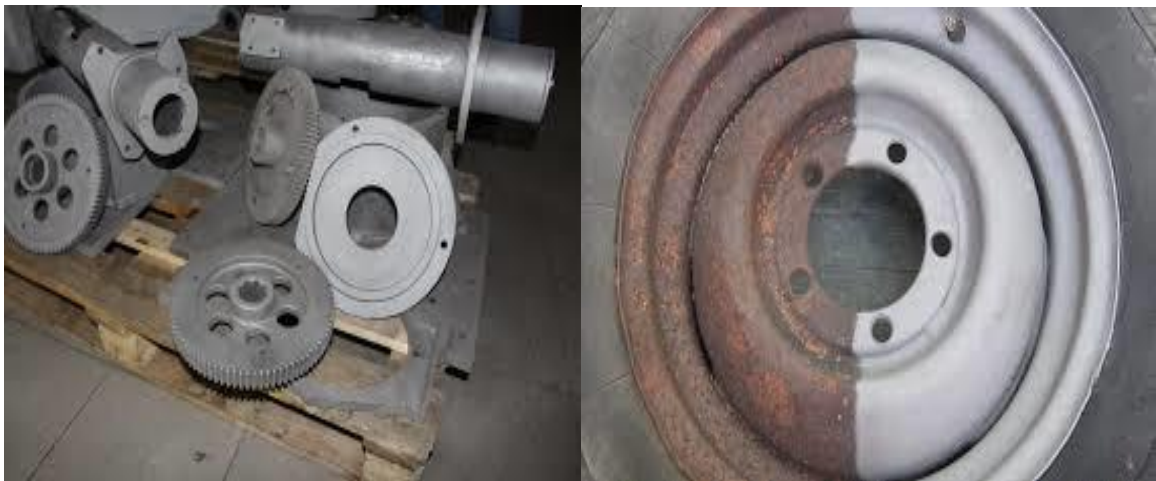
Qumlama – qumla təzyiq altında təmizləmə əməliyyatı
