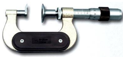
Микрометрические зубомеры МЗ 25–1 ГОСТ 6507–2000
