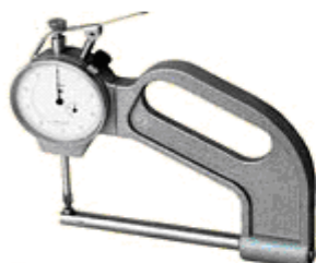
Индикаторные толщиномеры для измерения стен деталей.
