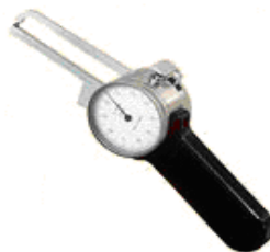
İndikatorlu divarqalınlığı (detallarda) ölçənlər C-2 ГОСТ 11358-2001 C-10A ГОСТ 11358-2001 C-25 ГОСТ 11358-2001 C-10Б ГОСТ 11358-2001
