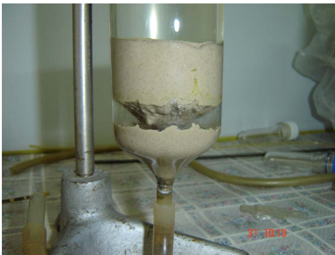
Рис. 5.9. Образование трещины в результате химической реакции.
