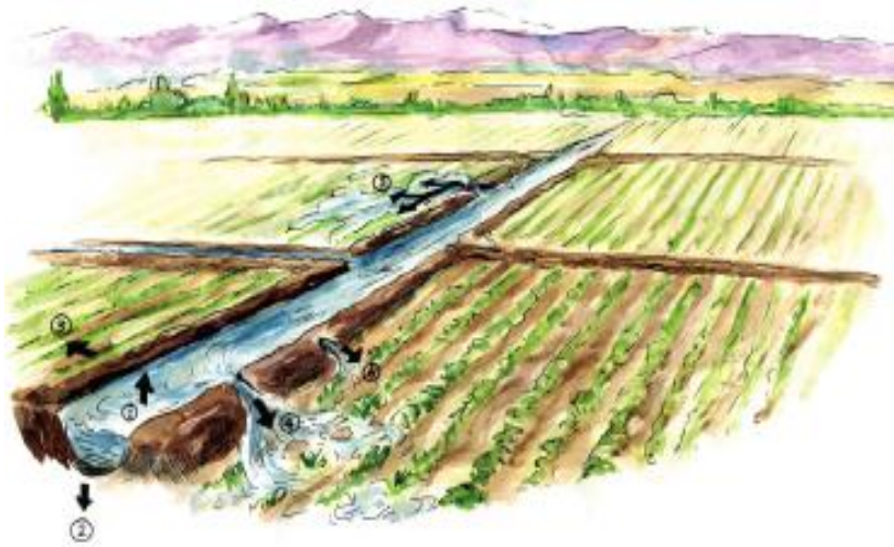
Şəkil 5.7. Suvarma kanallarında su itkiləri
