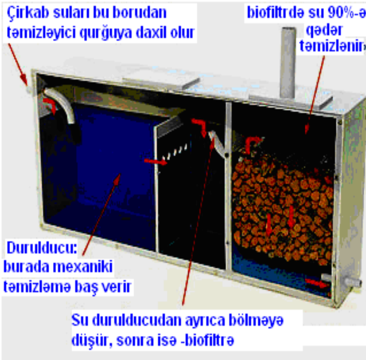
Şəkil 10.39. Bioloji filtrlə çirkab suyunun təmizlənməsinin sxemi
