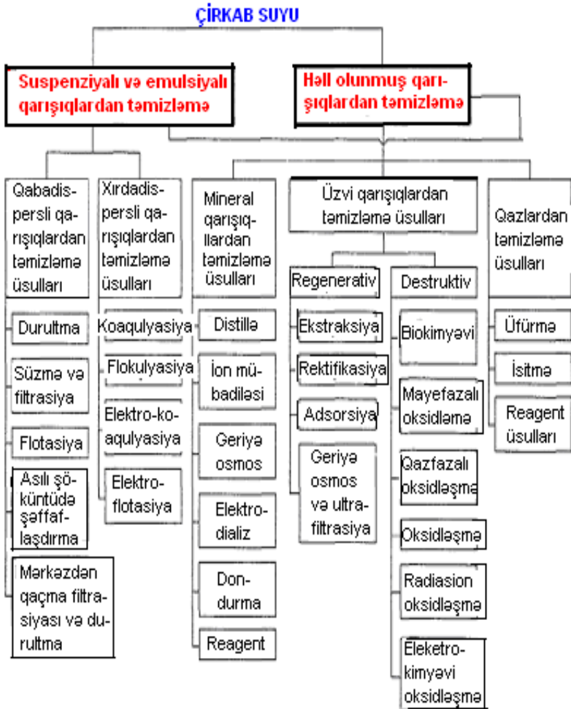
Şəkil 10.2. Çirkab sularının təmizlənməsi üsullarının təsnifatı
