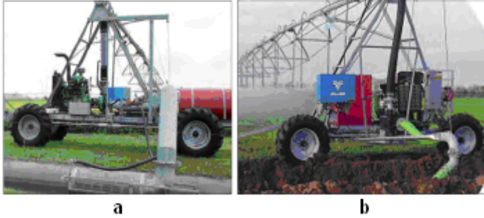
Şəkil 5.30. Suvarma maşınlarının su ilə qidalanması mənbələri
