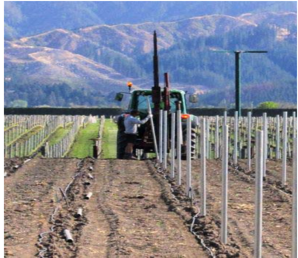
Şəkil 58. Mexaniki üsulla sahənin şpalerə qaldırılması (hidravlik dirək basdıran)
