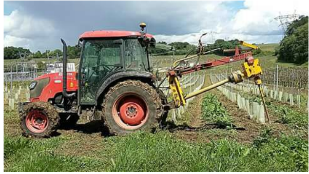
Şəkil 56. Mexaniki üsulla şpalerin yerinin açılması
