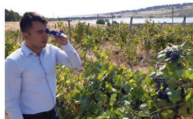
Şəkil 19. Üzüm sortlarında tarla refraktometri vasitəsilə şəkərliliyin təyini
