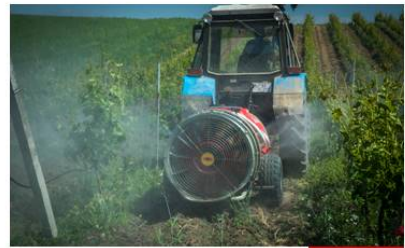
Şəkil 11. Layihə çərçivəsində alınmış “Tənəkərası becərən hidravlik frez” və “Çiləyici ventilyatorlu qoşulan karataş T-1000” aparatı
