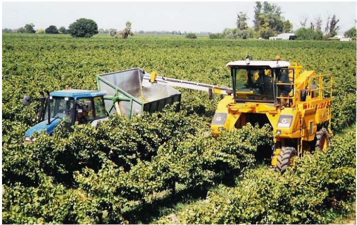
Şəkil 42. Üzümün mexaniki qaydada yığılması
